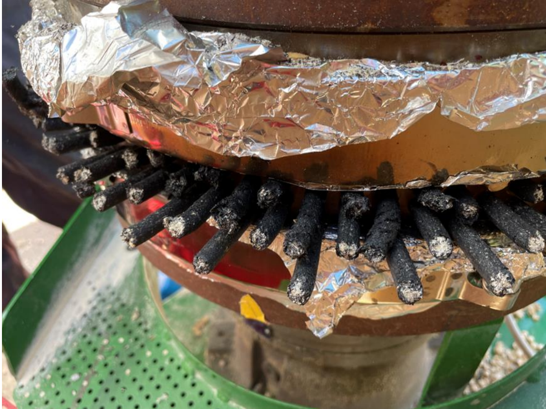
Kuva 5. Sekoitepelletti 50 % / 50 % valmistus pellettikoneella.
