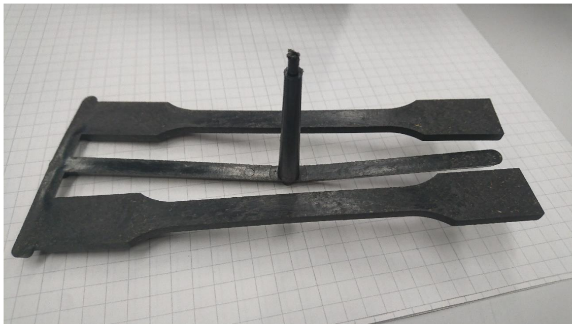
Kuva 7. Puukuitua 50 % sisältävä testikappale.
