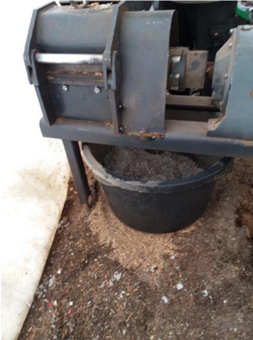
Kuva 1. Konepaja M. Pappisen tekemä muskain, jolla maatalousmuovi murskattiin.
